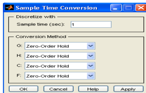
شکل ۱۱. گسسته‌سازی سیستم در جعبه ابزار sisotool
