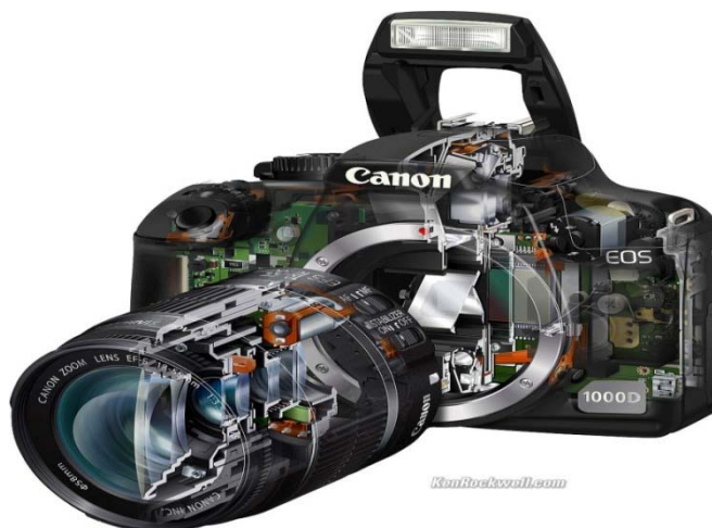
شکل ۲۱. نمایی از برش عرضی بر روی یک دوربین دیجیتالی که قسمت‌هایی از سیستم فوکس اتوماتیک CCD را نشان می‌دهد
